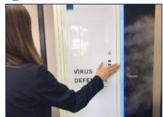
ハンドモードを選択して頂くことにより、センサー部分に手をかざして必要な時にだけ無駄なくミスト放出が可能。溶液のコストを抑えながらご利用頂けます。
